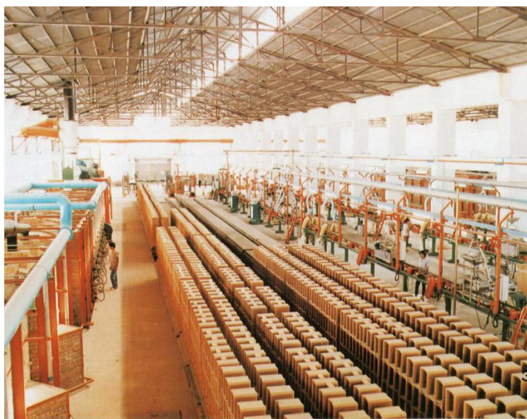
中山陶瓷厂新引进的釉面墙地砖生产线 图片来源：《中山》（1986）画册
